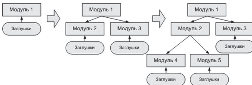
Рис. 2. Поэтапная интеграция модулей при нисходящем методе тестирования
