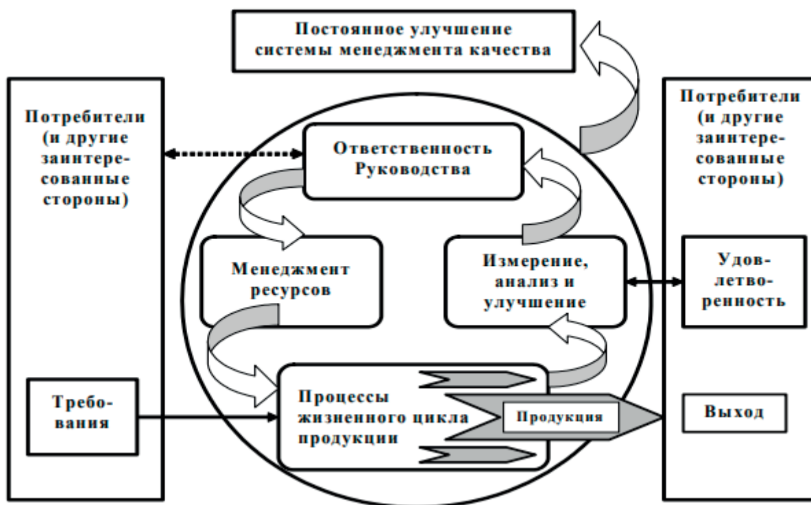
Рис. 1. Модель системы менеджмента качества, основанной на процессном подходе в соответствии со стандартами ГОСТ Р ИСО 9001-2001 и ГОСТ Р ИСО 9004-2000
