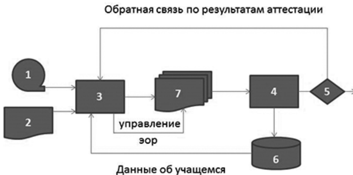
Рис. 2. Система адаптивного управления учебным процессом с использованием модели студента. 1 – учебные планы, 2 – образовательные ресурсы, 3 – управляющее устройство (система управления учебным процессом), 4 – студент, 5 – процедура аттестации, 6 – модель студента, 7 – электронный образовательный ресурс с перестраиваемым интерфейсом
