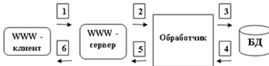
Рис. 1. Механизм выдачи информации ИОС
